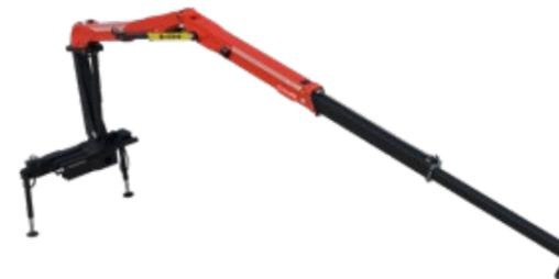
**TZ12** • Flexible und schnell ausfaltbare Krane in Z-Bauweise, die sowohl in Einfach- als auch in Doppel-Teleskopausführung erhältlich sind. Verfügbar von kompakten 7,7 Metern bis zu langen 10,5 Metern.
